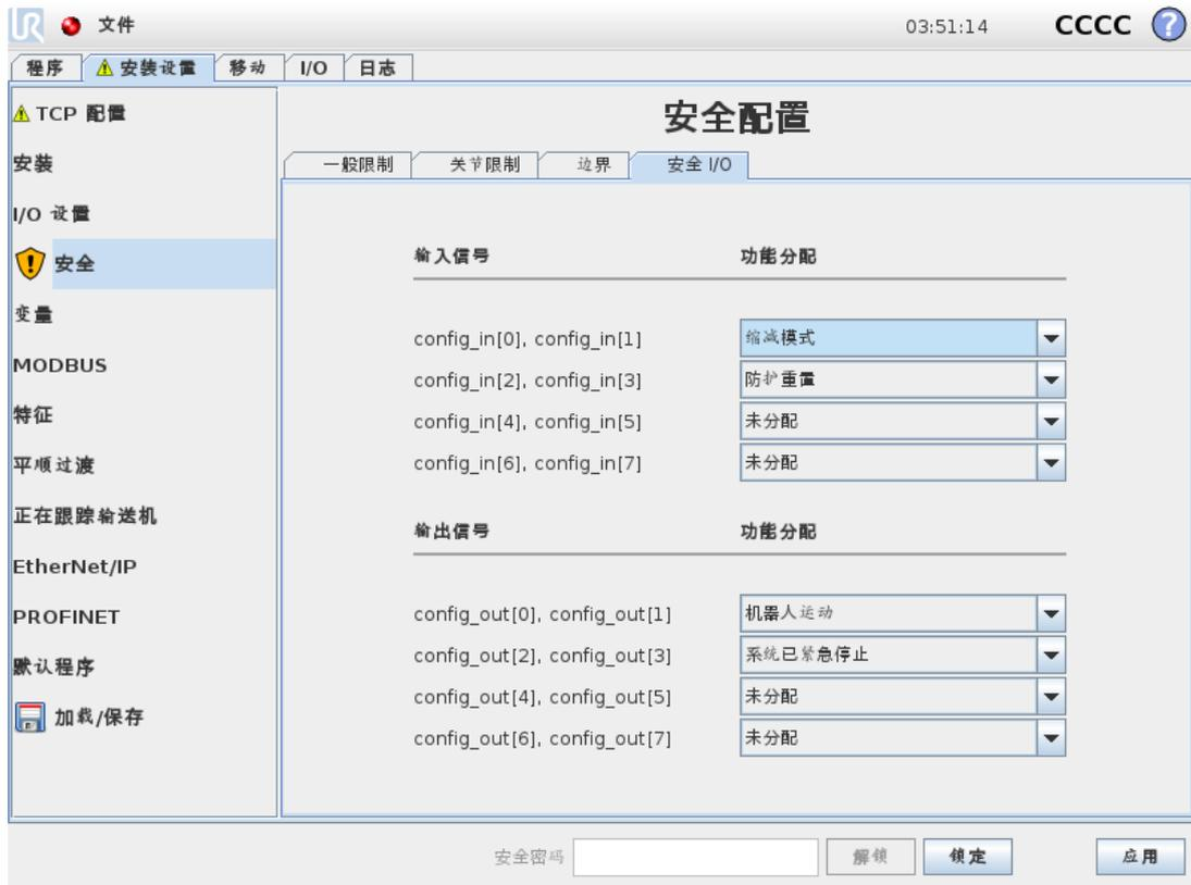
此屏幕用于定义可配置输入和输出 (I/O) 的安全功能。I/O 被分为输入和输出，并成对出现以便为每个功能提供 3 类<sup>1</sup> PLd I/O。
