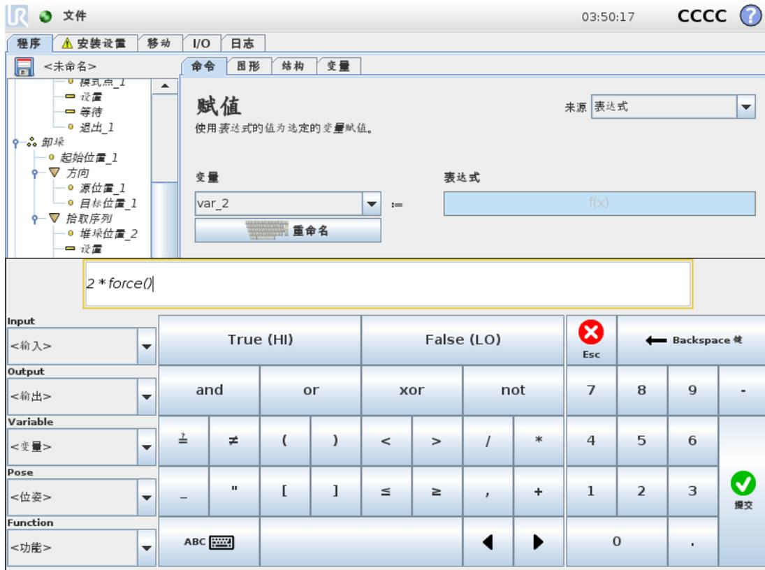
虽然表达式本身是以文本形式进行编辑,但表达式编辑器也提供了许多按钮和函数,可用于插入特殊表达式符号,例如,表示相乘的 \* 符号和表示小于等于的 ≤ 符号。使用屏幕左上角的键盘符号按钮可切换至表达式文本编辑模式。可以在 Variable selector, while the names of the input and output ports can be found in the Input and Output selectors. Some special functions are found in Function 中找到所有已定义的变量。
