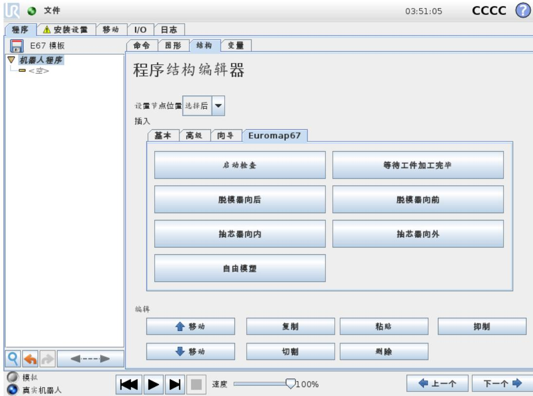
所有结构都可实现与 IMM 进行正确安全的交互,因此,这些结构都包括用于确定特定信号设置是否正确的测试。此外,这些结构可能会设置多个输出来启动一个动作。
