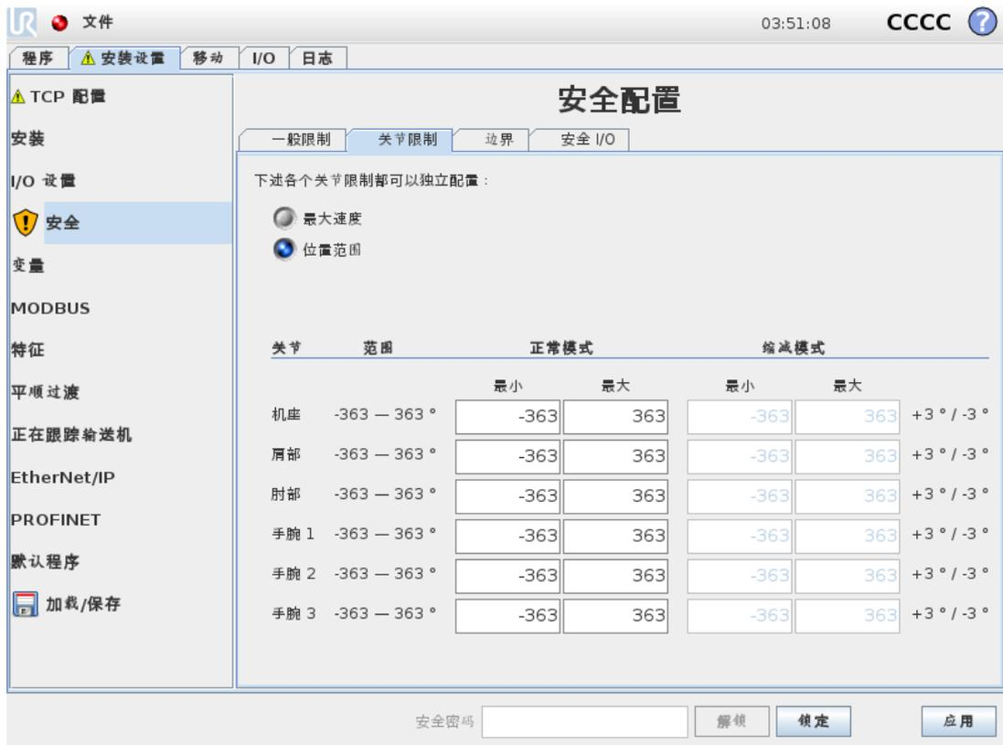
关节限值用于限制每个关节在关节空间中的移动, 即它们不是指笛卡尔空间, 而是指关节的内部(旋转)位置及其旋转速度。子面板上部的单选按钮可以独立设置关节的 Maximum Speed and Position Range。
