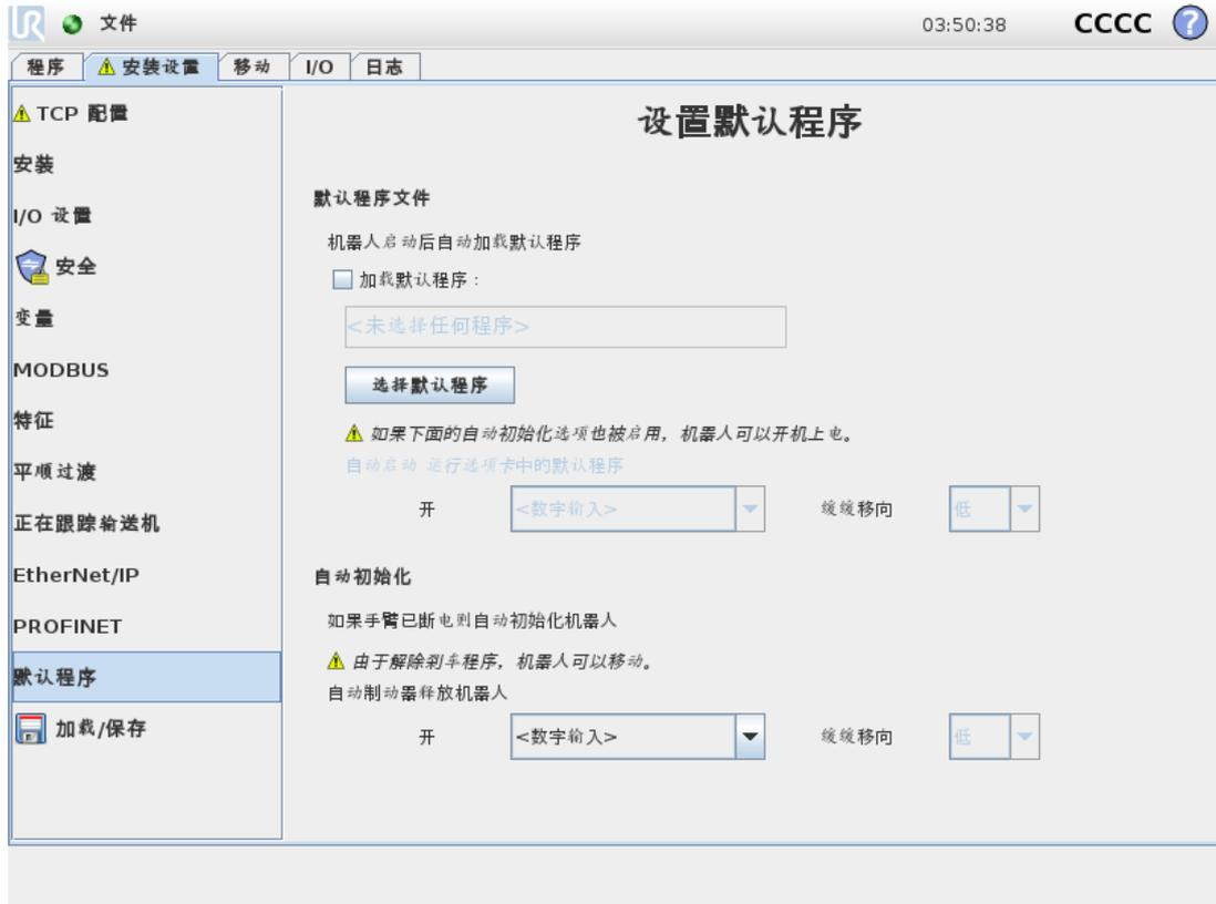
启动屏幕包含自动加载设置、启动默认程序，以及在启动时，自动对机器手臂进行初始化。
