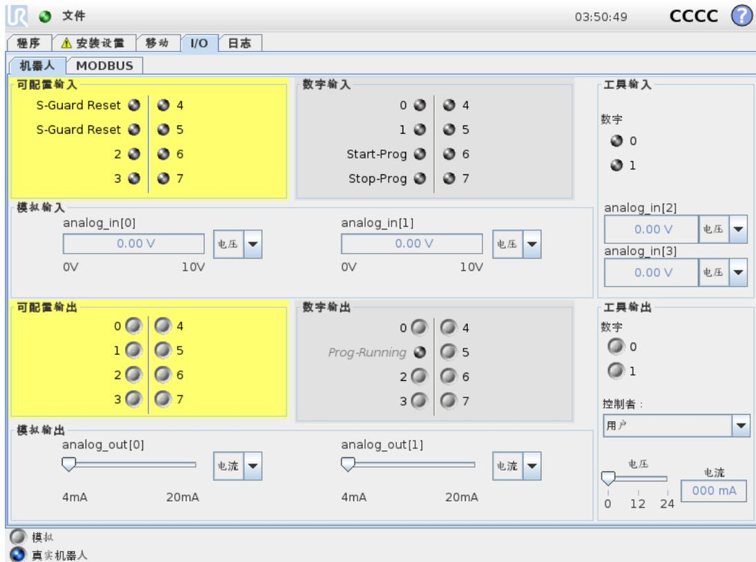
在此屏幕上，您可以始终监控并设置机器人控制箱收发的实时 I/O 信号。屏幕将显示 I/O 的当前状态，包括程序运行期间的 I/O 状态。程序运行期间如有任何更改，程序将停止运行。程序停止运行时，所有输出信号将保持其状态。屏幕的更新频率为 10Hz，因此，特别快的信号可能无法正确显示。
