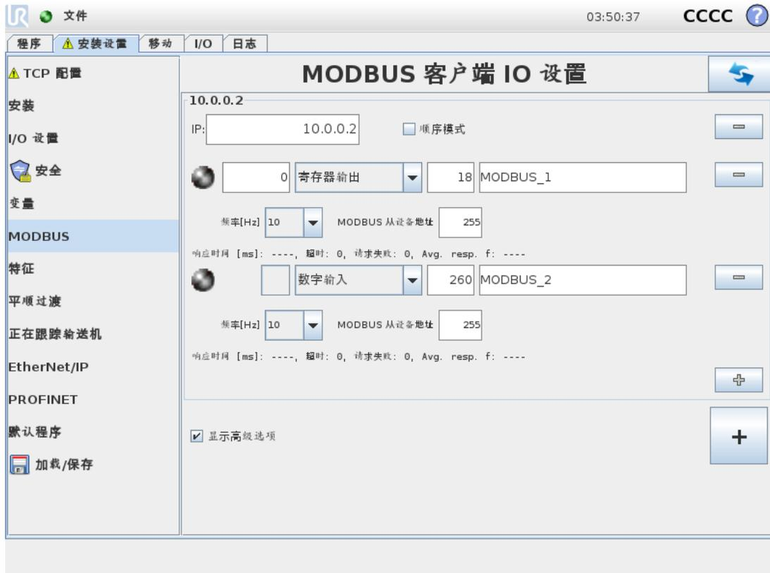
此处可设置 MODBUS 客户端(主)信号。可由输入/输出信号(寄存器或数字)创建与指定 IP 地址的 MODBUS 服务器(或从设备)的连接。每个信号都有唯一的名称 ,因此可用在程序中。
