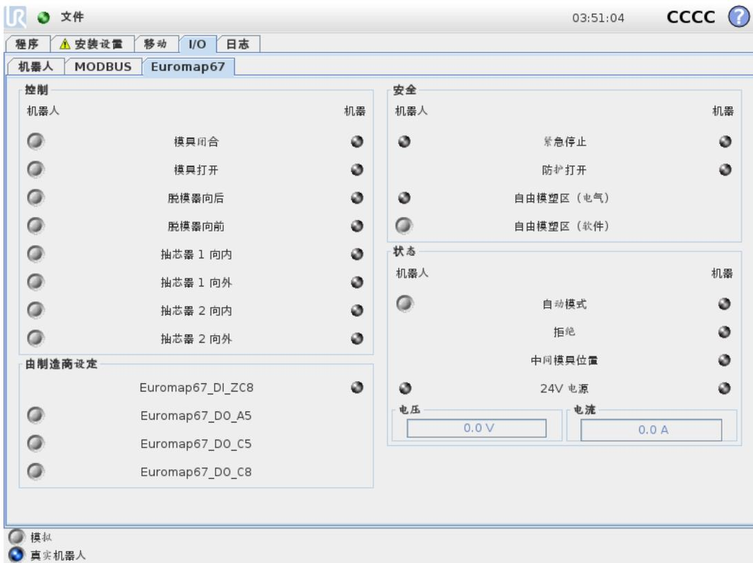
此屏幕中有四个框架,下面将逐一介绍。这四个框都包含机器人和机器这两列,分别显示用于控制输出信号的按钮以及用于显示输入信号状态的指示器。
