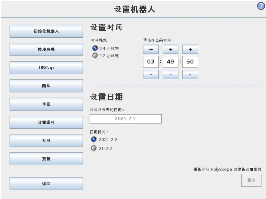
设置系统的时间和日期，并配置时钟的显示格式。时钟显示在运行程序和为机器人编程屏幕顶部。轻触时钟将立即显示日期。必须重新启动 GUI，所做更改方可生效。
