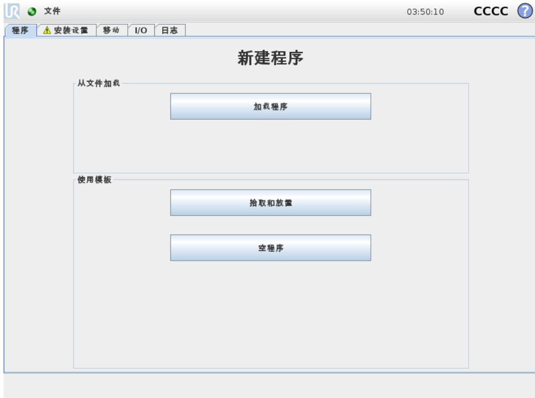
可以通过使用模板或参照现有(已保存的)机器人程序创建新的机器人程序。模板可以提供整个程序结构,因此只需填写程序的详细信息。
