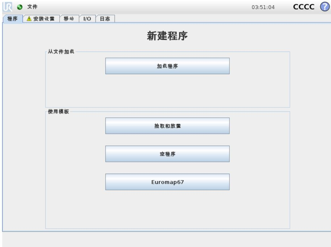
选择 EUROMAP 67 程序模板后，将在程序屏幕上显示加载的模板。随后，屏幕左侧将显示模板结构。
